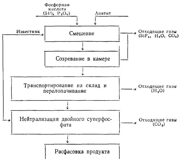
С х е м а 1. Получение двойного суперфосфата из упаренной фосфорной кислоты камерным способом.
