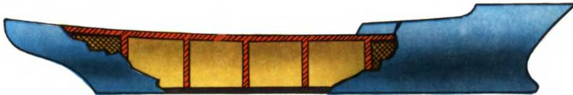
Рис. 32. Разделение судна (модели) водонепроницаемыми переборками.
