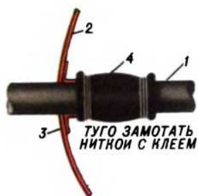
Рис. 196. Герметизация баллера: 1 — баллер; 2 — обшивка корпуса; 3 — втулка; 4 — резиновая трубка.
