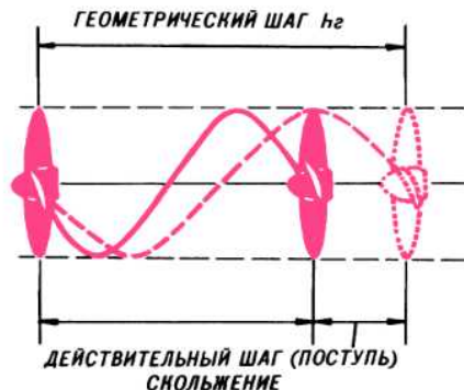
Рис. 141. Шаг, поступь и скольжение гребного винта.
