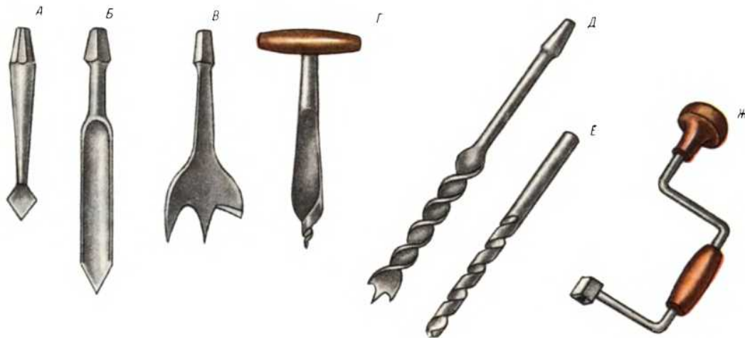
Рис. 15. Сверла по дереву: А — перовое; Б — ложечное; В — пёрка; Г — буравчик; Д — винтовое; Е — спиральное по металлу; Ж — коловорот.
