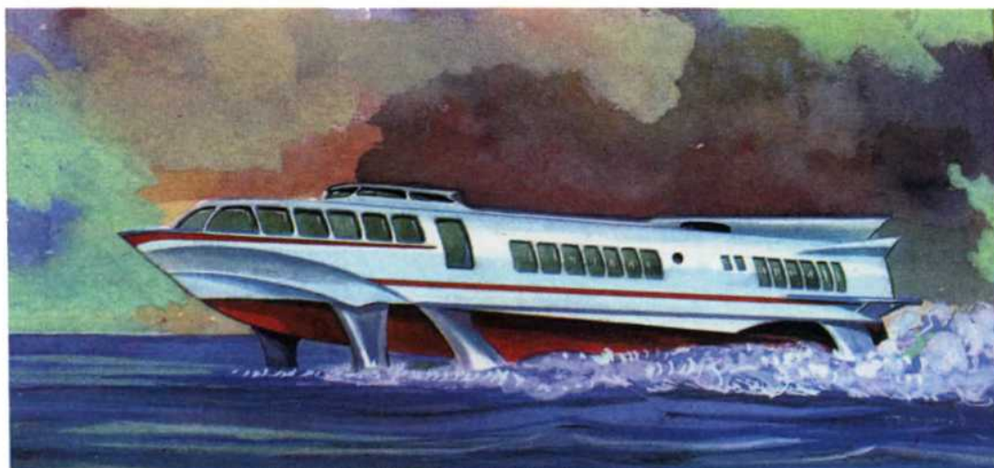
Рис. 56. Судно «Метеор» на полностью погруженных подводных крыльях.
