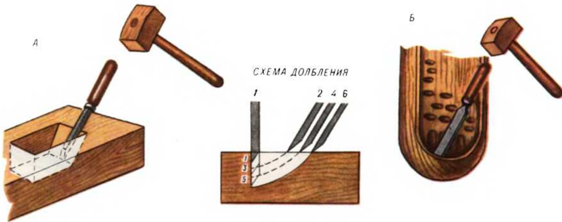
Рис. 14. Долбление древесины; А — плоское; Б — фасонное.
