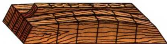
Рис. 63. Изготовление корпуса по батоксам.
