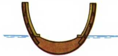
Поперечный разрез древнерусской набойной лодки.
