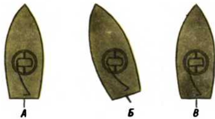
Рис. 162. Схема работы автомата сохранения курса.
