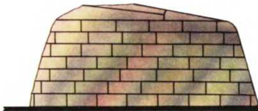
Рис. 70. Корпус, опаиванный кусками жести.
