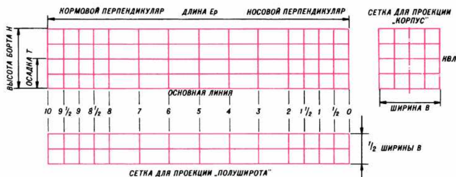
Рис. 39. Сетка для построения теоретического чертежа.
