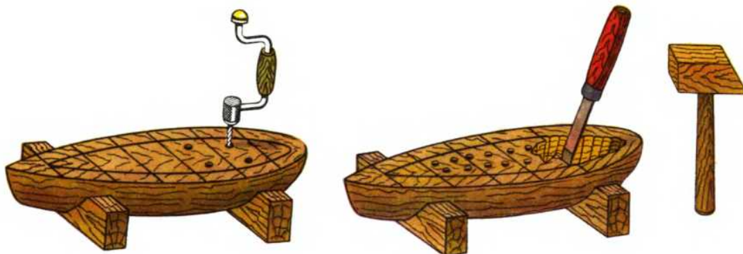
Рис. 59. Выдалбливание корпуса модели.
