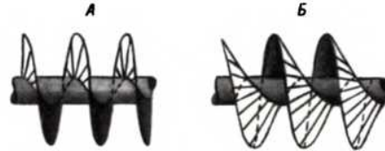
Рис. 137. Формы винтовых поверхностей: А — с прямоугольной образующей; В — с некоторым углом к оси.
