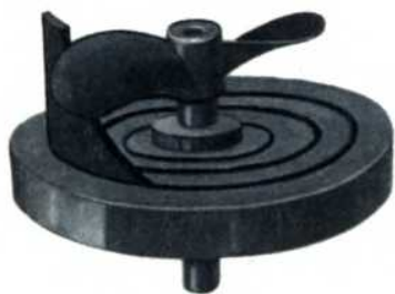
Рис. 150. Приспособление для контроля величины шаговых углов при закрутке лопастей.
