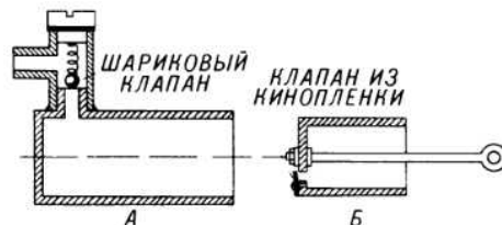
Рис. 171. Клапаны компрессора; А — шариковый; Б — из киноплёнки.
