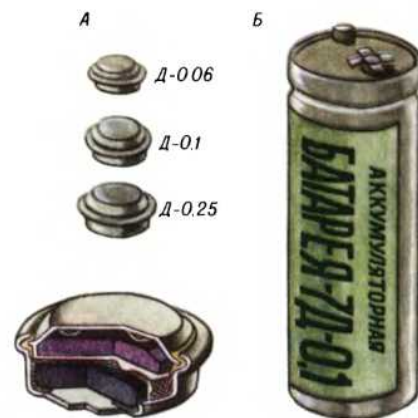
Рис. 130. Герметические аккумуляторы: А — элементы Д—0,06; Д—0,1; Д—0,25; Б — батарея Д7—0,1.
