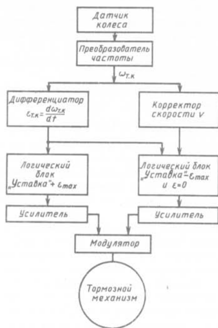
Рис. 204. Блок-схема управления АБС
