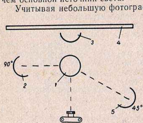
Рис. 84. Расположение источников света в портретной съемке при искусственном освещении: 1 — объект съемки; 2 — дополнительный источник света; 3 — подсветка фона; 4 — фон; 5 — осветитель.
