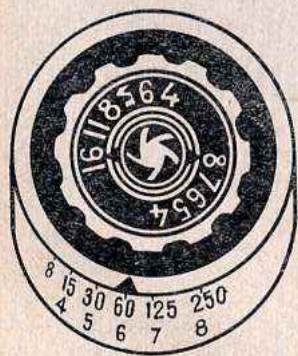
Рис. 28. Определение выдержки по экспозиционному числу.
