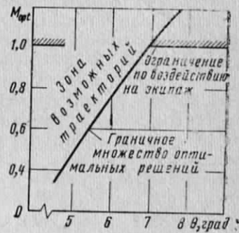
Рис. 3.5. Зависимость меры интегрального перегрузочного воздействия для оптимальных траекторий от угла \theta входа в атмосферу
