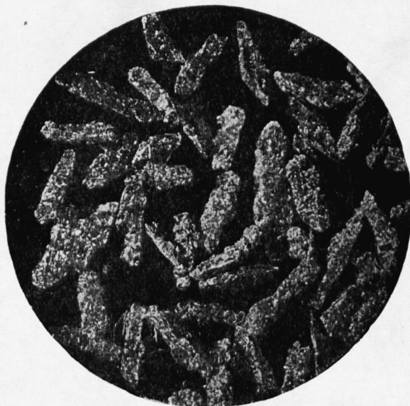
Рис. 35. Абразивное зерно игольчатой (мечевидной) формы
