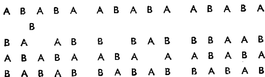
Ф и г. 3. Дефекты в соединении стехиометрического состава.
