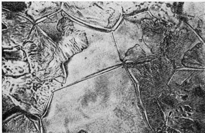
Ф и г. 24. Неразрешенная перлитная структура, полученная при 420 °С [6]. \times 2000 .
