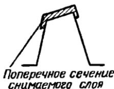
Фиг. 53. Схема снятия стружки трапецидальными метчиками.
