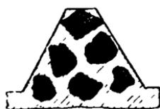
Фиг. 166. Положение зерна при накатывании.
