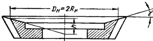
Фиг. 21. Заточка инструмента при угле  $\omega < 1^\circ$ .
