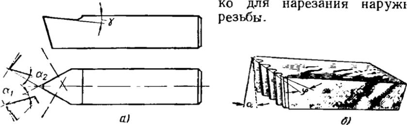
Фиг. 2. Виды резьбовых резцов:
