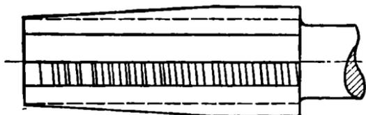
Фиг. 43. Метчик гаечный с прямой канавкой.
