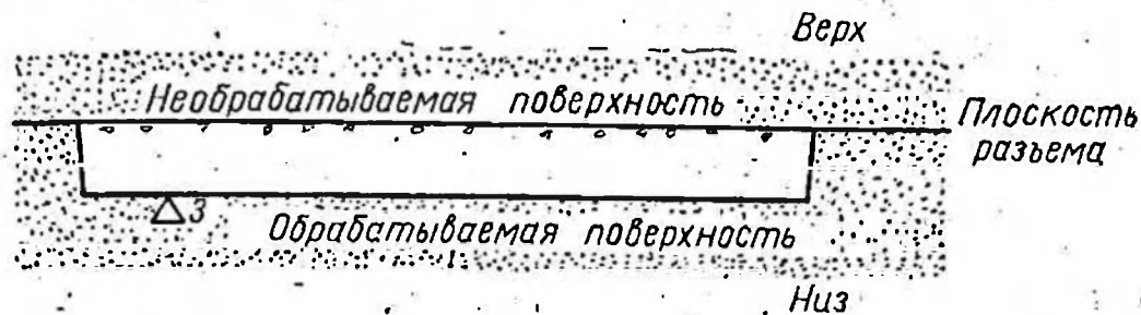
Фиг. 23. Обрабатываемые поверхности необходимо при заливке располагать по возможности вниз.
