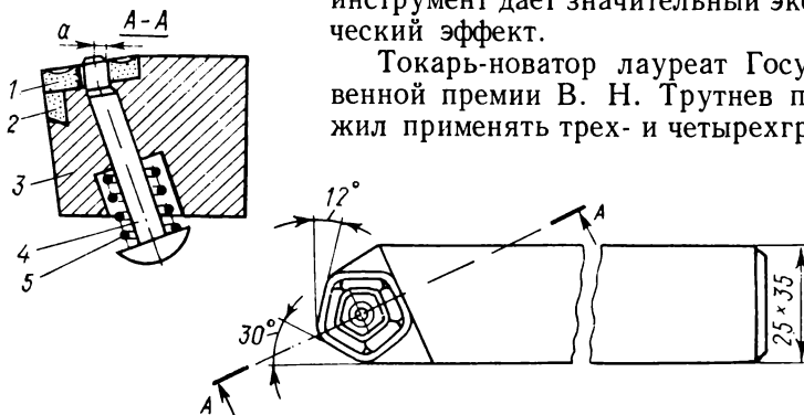
Рис. 51. Токарный проходной резец конструкции В. К. Семинского с неперетачиваемой многогранной твердосплавной пластинкой и механическим креплением
