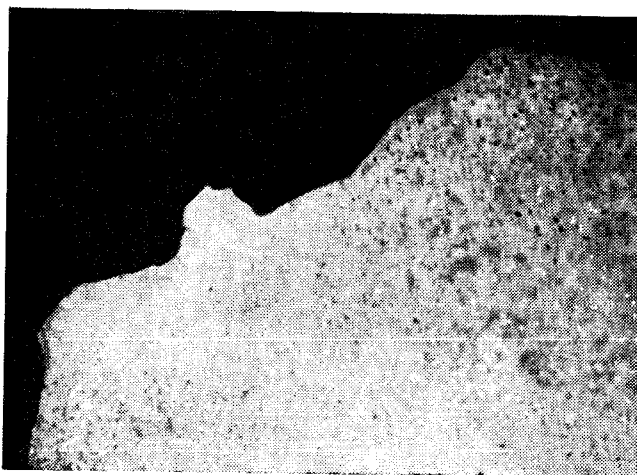
Рис. 70. Металлургия кристаллизации шва; «твердые» выступы
