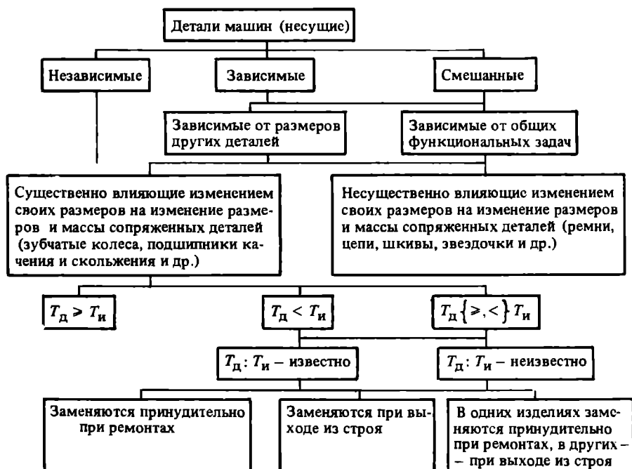
Рис. 4.2. Классификация деталей машин применительно к задачам построения параметрических рядов
