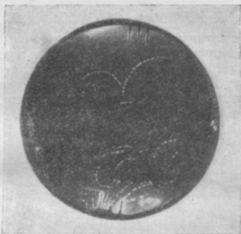
Рис. 14. Образование пары электрон — позитрон из светового гамма-кванта. В магнитном поле налево (наверху) отклонен позитрон, направо — электрон (фотография А. В. Грошева и И. М. Франка)
