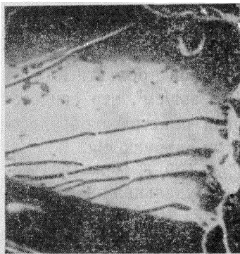
Рис. 6 Трещина скола (в той же стали, что на рис. 5) в нижнем субзерне, вызвавшая образование серии мелких трещин, разделенных большими ступеньками, в верхнем субзерне. Стереоскан, \times 750
