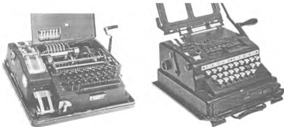
Рис. 60 в. Слева: шифратор BC-543 (Компания «Хагелин Криптограф», США); справа: немецкая копия с шифратора С-41 фирмы «Wanderer Werke»
