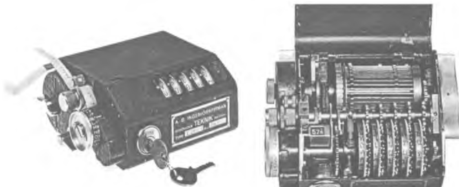
Рис. 60 а. Шифратор С-35, созданный Б. Хагелином (А. В. Cryptoteknik, Стокгольм)
