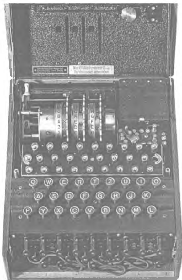
Рис. 50 а. Трехроторная ЭНИГМА Вермахта (1937 г.)
