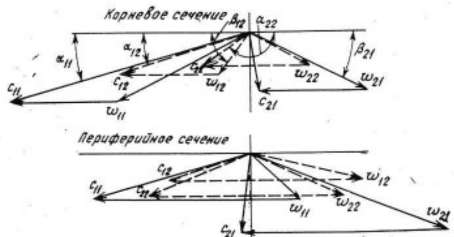
Рис. 5-19. Треугольники скоростей пара и влаги в корневом и периферийном сечениях ступени с длинными лопатками.
