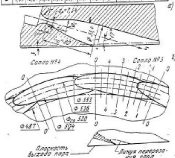
Рис. 6-14. Геометрические размеры сопловой решетки со сверленными соплами (а) и сечения, в которых производились замеры (б).
