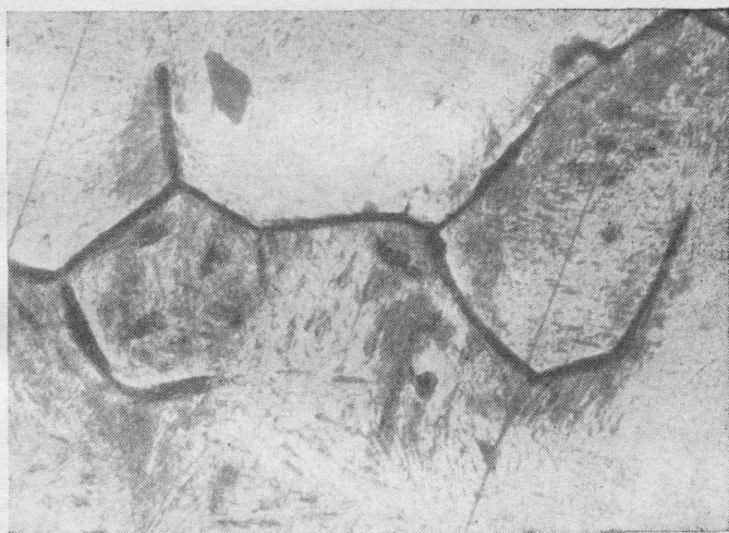
Рис. 20. Трещины, образующиеся при коррозии под напряжением стали 30ХГСНА в 20% \text{H}_2\text{SO}_4 + \text{NaCl} (30 кг/м 3 ). \times 500
