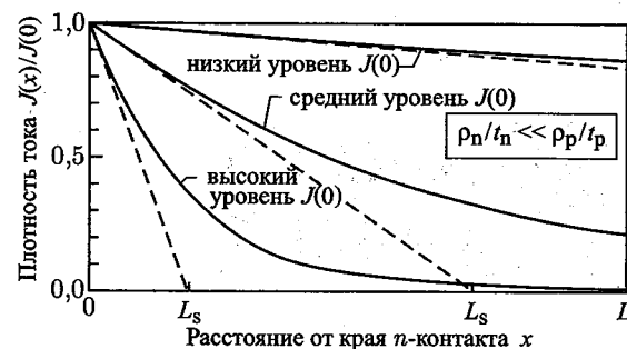
Рис. 8.12. Распределение плотности тока при высоком, среднем и низком значениях тока, нормированных на начальную плотность тока, в светодиодах с поперечной инжекцией носителей тока. Предполагается, что сопротивление слоя n -типа намного меньше сопротивления слоя p -типа
