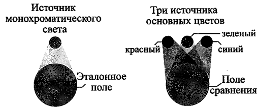
Рис. 17.1. Принцип согласования цветов. Область, освещаемая тремя источниками основных цветов: красным, зеленым и синим, обозначенная «поле сравнения», выравняется по цвету с областью, освещаемой эталонным источником монохроматического света
