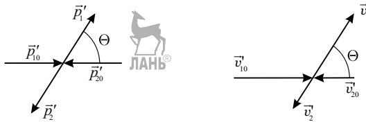
Рис. 2.7. Диаграммы импульсов и скоростей частиц в СЦМ
