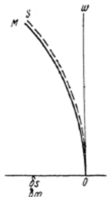
Рис. 35. График системы с исправленным астигматизмом и значительной кривизной поля.
