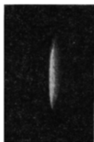
Рис. 44. Астигматическое изображение щели от двух зеркал диаметром: а — 50 мм, б — 100 мм.
