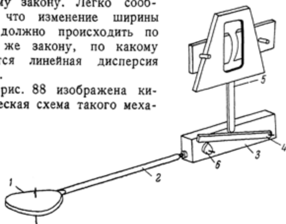
Рис. 88. Схема механизма раскрытия щели для выделения спектрального интервала постоянной ширины.
