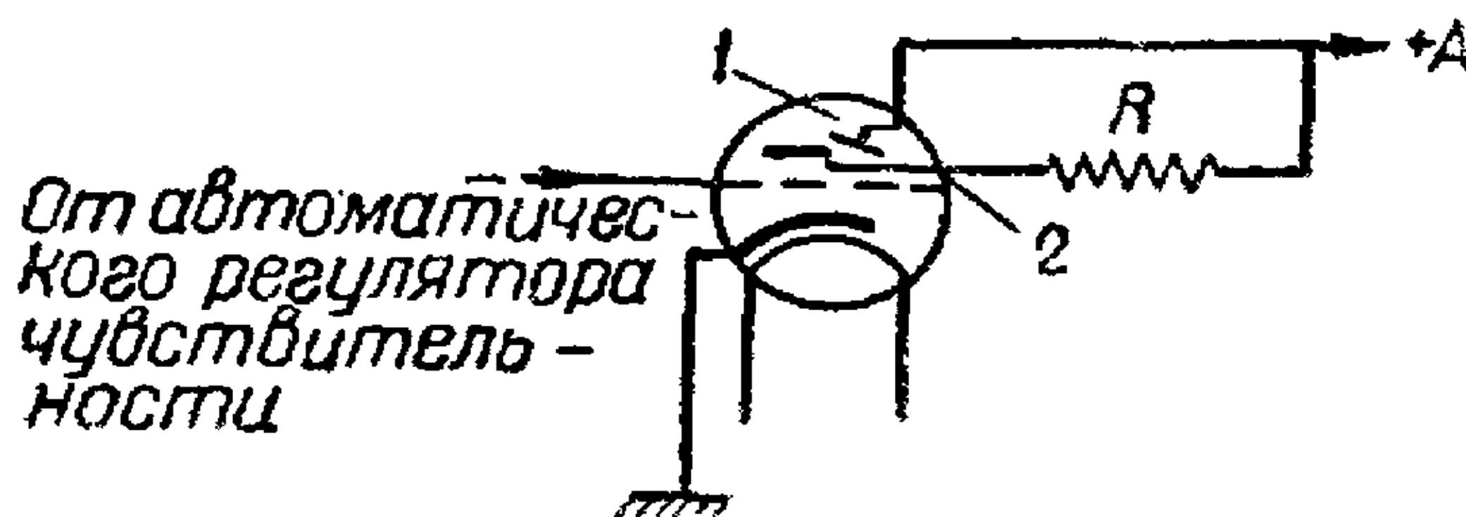
Рис. 153. Схема включения оптического индикатора: 1 — светящийся экран; 2 — управляющий электрод.
