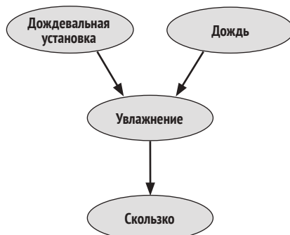
Рис. 13.2. Простой пример причинно-следственной байесовской сети, которая представляет следующие связи: Дождевальная установка (Sprinkler) – причина Увлагнения (Wet), Дождь (Rain) – причина Увлагнения (Wet), а Увлагнение (Wet) – причина скользкого состояния травы (Slippery) (пример взят из книги Дж. Перла (J. Pearl) [3])
