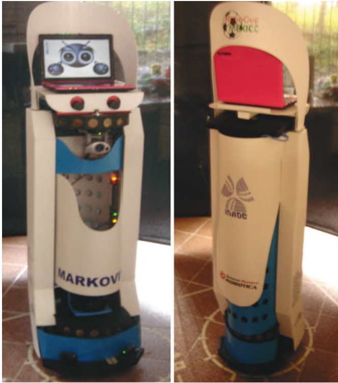
Рис. 11.6. Обслуживающий робот Markovito
