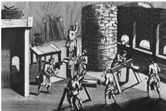
Рис. 24.3 Техника обработки стеклянных цилиндров для изготовления плоских пластин, 1751–1752 гг. [122]
