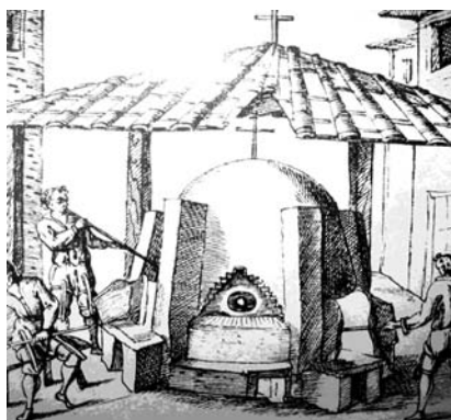
Рис. 24.4 Печь для варки стекла. Из собрания Музея стекла в Мурано (фото авторов)
