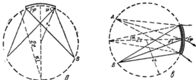
Рис. 51. Принцип работы спектрометра с изогнутым кристаллом, работающим в методе отражения (а) и в методе прохождения (б); А — источник, В — изображение.
