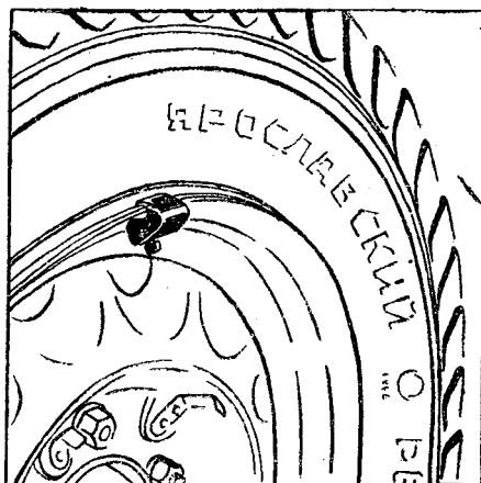
Рис. 58. Способ крепления балансирных грузиков на обод колеса.
