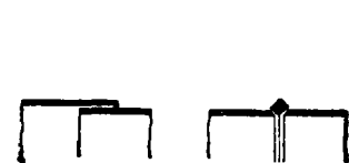
Фиг. 161. Сварка листов в напуск.
