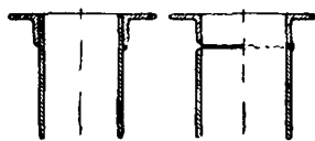
Фиг. 198. Наварка фланцев.
