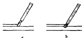
Фиг. 202 a и b . Плохой и правильный способы ведения дуги.
