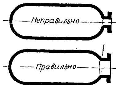
Фиг. 82 а и б. Правильная и неправильная форма воздушного колпака.
