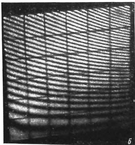
Рис. 82. Голографические интерферогаммы деформированной упругой пластинки, восстановленные по разным участкам одной и той же голограммы [198].
