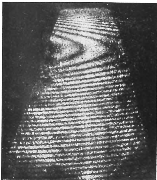
Рис. 83. Интерференционные полосы, полученные методом двух экспозиций при деформации балки длиной 195 см [60].
