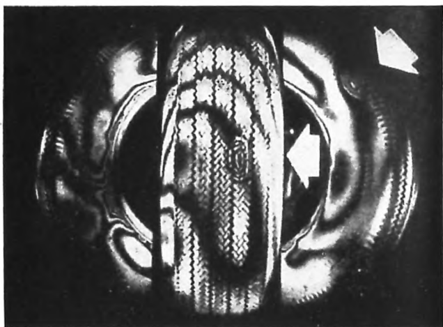
Рис. 84. Интерференционные полосы, полученные при испытаниях шин.
