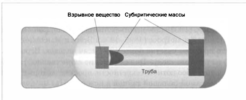
Схема взрывного механизма, в котором одна из субкритических масс выстреливается посредством условного взрывного вещества и попадает в другую субкритическую массу.
