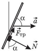
$F_{\text{тр}} \sin \alpha - N \cos \alpha = 0$ . Минимальное значение угла  $\alpha$  достигается, когда сила трения покоя принимает максимальное значение:  $F_{\text{тр}} = \mu N$ . Объединяя записанные выражения, получаем:  $\alpha_{\min} = \arctg(1/\mu) \approx 84,3^\circ$ .
