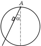
**Решение.** Уравнение движения бруска по желобу, составляющему угол  $\alpha$  с вертикалью, имеет вид:  $ma = mg \cos \alpha - \mu mg \sin \alpha$ , откуда ускорение бруска  $a = g(\cos \alpha - \mu \sin \alpha)$ . Из кинематического соотношения  $\tau = \sqrt{\frac{2L}{a}}$ , где  $L = D \cos \alpha$  — путь, пройденный бруском до точки
