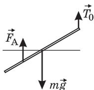
Решение. Плавающая палочка находится в равновесии под действием сил, изображенных на рисунке, где  $m\vec{g}$  — сила тяжести,  $\vec{F}_A$  — архимедова сила,  $\vec{T}_0$  — сила натяжения нити. Из уравнения моментов, записанного относительно оси, проходящей через точку подвеса палочки, получаем:  $\rho SL \cdot \frac{L}{2} \cos\alpha = \rho_B S \frac{L}{2} \cdot \frac{3L}{4} \cos\alpha$ ,
