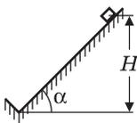
**Решение.** Пусть  $m$  — масса тела. Модуль силы трения, действующей на тело,  $F_{\text{тр}} = \mu mg \cos\alpha$ . Путь, пройденный телом по наклонной плоскости от начального до конечного положения,  $S = \frac{H+h}{\sin\alpha}$ .
