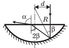
отраженного от посеребренной поверхности луча на плоскую поверхность линзы составляет  $2\beta$ . По закону преломления  $\sin \alpha = n \sin 2\beta$ . Используя формулу  $\sin 2\beta = 2 \sin \beta \cos \beta$ , определяем  $\alpha$ .
