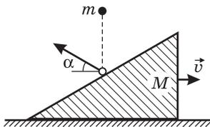
Решение. Пусть  $u_0$  и  $u$  — модули скоростей шарика до и после соударения с клином соответственно. Для тела, падающего без начальной скорости с высоты  $h$ , имеем:  $u_0 = \sqrt{2gh}$ . Из закона сохранения проекции импульса системы «шарик + клин» на горизонтальную ось следует, что  $mu \cos \alpha = Mv$ . При упругом соударении шарика и клина сохраняется суммарная кинетическая энергия этих тел:
