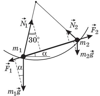
причем  $\vec{F}_1 = -\vec{F}_2$ , т. к. стержень невесом и находится в покое. В проекции на направление стержня условие равновесия шариков имеет вид:  $N_1 \sin 30^\circ - m_1 g \sin \alpha = N_2 \sin 30^\circ + m_2 g \sin \alpha$ . Записывая правило моментов относительно осей, проходящих через точки  $m_1$  и  $m_2$ , получаем:  $m_2 g \cos \alpha = N_2 \cos 30^\circ$ ,  $m_1 g \cos \alpha = N_1 \cos 30^\circ$ , откуда
