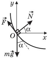
Решение. Брусок движется по горизонтальной окружности под действием сил, изображенных на рисунке, где  $m\vec{g}$  — сила тяжести,  $\vec{N}$  — нормальная составляющая силы реакции сферы,  $\vec{F}$  — сила трения. В проекциях на оси  $Ox$  и  $Oy$  неподвижной координатной системы имеем:
