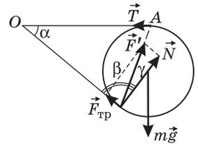
Разложим силу  $\vec{F}'$  на две составляющие: силу нормального давления  $\vec{N}$  и силу трения  $\vec{F}_{\text{тр}}$ . Из рисунка видно, что  $F_{\text{тр}} = N \operatorname{tg} \gamma$ . Поскольку величина силы трения покоя  $F_{\text{тр}} \leq \mu N$ , значение коэффициента трения, при котором цилиндр находится в равновесии, удовлетворяет условию:  $\mu \geq \operatorname{tg} \gamma$ . Минимальное значение коэффициента трения
