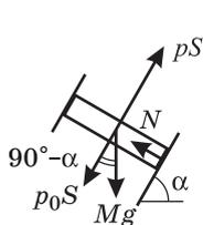
**Решение.** При нагревании газ перемещает поршень, совершая изобарное расширение. Поскольку молярная теплоемкость идеального одноатомного газа при постоянном давлении  $C_p = \frac{5}{2}R$ , количество теплоты, сообщенное газу, равно
