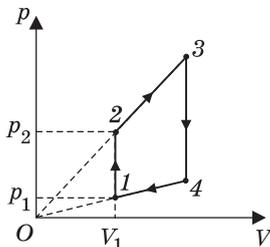
Решение. Работа газа в циклическом процессе численно равна площади фигуры, отображающей процесс на  $pV$ -диаграмме. В данном случае работа равна площади трапеции:
