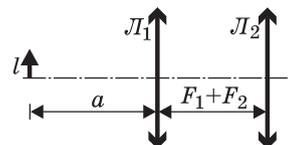
Решение. Построение изображения предмета в системе линз показано на рисунке. Первая линза дает действительное изображение, расположенное на расстоянии  $b$  позади нее. Применяя формулу линзы  $\frac{1}{a} + \frac{1}{b} = \frac{1}{F_1}$ , получаем,
