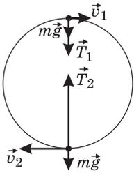
$\frac{mv_2^2}{l} = -mg + T_2$  (в нижней точке). По закону сохранения энергии,  $\frac{mv_1^2}{2} + 2mgR = \frac{mv_2^2}{2}$ . Объединяя записанные выражения, получаем:  $m = \frac{T_2 - T_1}{6g} \approx 0,017$  кг.
