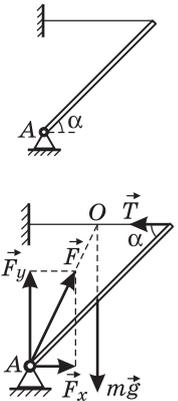
*Замечание.* Поскольку линии действия сил  $mg$  и  $T$  пересекаются в точке  $O$ , линия действия силы  $F$  также должна проходить через эту точку, что позволяет до решения задачи однозначно определить направление силы реакции шарнира.
