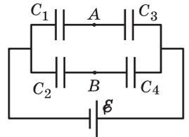
**3.1.27.** В схеме, показанной на рисунке, емкости конденсаторов равны:  $C_1 = 1$  мкФ,  $C_2 = 2$  мкФ,  $C_3 = 3$  мкФ,  $C_4 = 4$  мкФ. Напряжение между точками  $A$  и  $B$  равно  $U = 100$  В. Найти напряжение  $U_4$  на конденсаторе  $C_4$ . Первоначально конденсаторы были не заряжены.
