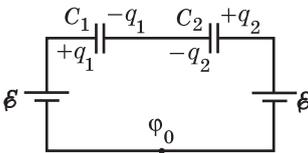
Решение. Когда ключ находился в положении 1, на конденсаторе  $C_1$  накопился заряд  $q_0 = C_1 \mathcal{E}$ . При переводе ключа в положение 2 заряд  $(-q_0)$ , находившийся первоначально на правой обкладке конденсатора  $C_1$ , перераспределится между ней и левой обкладкой конденсатора  $C_2$ . По закону сохранения заряда на этой системе обкладок имеем:  $-C_1 \mathcal{E} = -q_1 - q_2$ . При обходе кон-
