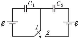
Найти заряды  $q_1$  и  $q_2$ , которые по истечении достаточно длительного времени накопятся на конденсаторах  $C_1$  и  $C_2$  соответственно. Емкости конденсаторов  $C_1 = 1$  мкФ,  $C_2 = 2$  мкФ, ЭДС каждого из источников  $\mathcal{E} = 30$  В.
