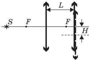
Решение. Построение изображения для случая, когда правая линза смещена, приведено на рисунке. Для построения использованы два луча, идущие от источника: луч 1, совпадающий с главной оптической осью левой линзы, и луч 2, проведенный в точку пересечения преломляющей плоскости левой
