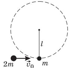
ка  $m$  после удара сохраняется его полная механическая энергия. Для нижней и верхней точек окружности, по которой движется этот шарик, получаем:  $m \frac{v_1^2}{2} = 2mgl + m \frac{u^2}{2}$ , где  $u$  — модуль скорости шарика в верхней точке.
