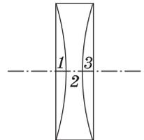
**Решение.** Оптическая сила системы из тонких линз, прижатых вплотную друг к другу, равна алгебраической сумме оптических сил линз, входящих в систему. Имеем:  $\frac{1}{F_1} + \frac{1}{F_2} = \frac{1}{F_{12}}$ ,  $\frac{1}{F_2} + \frac{1}{F_3} = \frac{1}{F_{23}}$ . Кроме того, поскольку все три линзы, сложенные вместе, образуют плоскопараллельную пластинку,  $\frac{1}{F_1} + \frac{1}{F_2} + \frac{1}{F_3} = 0$ . Решая полученную систему уравнений, находим, что
