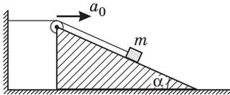
При этом относительное ускорение бруска  $\vec{a}_{\text{отн}}$  направлено вдоль наклонной поверхности клина вверх и, поскольку длина нити постоянна, по модулю совпадает с  $a_0$ . Из рисунка (а) видно, что
