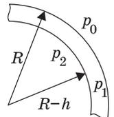
$\Delta p = p_2 - p_0 = \frac{4\sigma}{R} = \frac{8\sigma}{D}$ . Таким образом, избыточное давление
