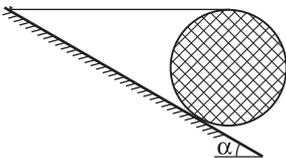
Решение. Цилиндр находится в равновесии под действием сил, изображенных на рисунке, где  $m\vec{g}$  — сила тяжести,  $\vec{T}$  — сила натяжения нити,  $\vec{F}'$  — сила реакции наклонной плоскости. Поскольку линии действия сил  $m\vec{g}$  и  $\vec{T}$  пересекаются в точке схода нити с блока  $A$ , и нить горизонтальна, линия действия силы  $\vec{F}'$  при равновесии цилиндра также проходит через эту точку.
