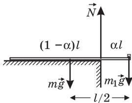
$\vec{N}$  — равнодействующая элементарных сил реакции, действующих на линейку со стороны стола. Поскольку по условию линейка не опрокидывается, точка приложения силы  $\vec{N}$  совпадает с краем стола. Уравнение моментов, записанное относительно оси, проходящей через край стола, имеет вид:
