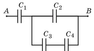
$C_1U_1 = CU_2$ ,  $C_3U_3 = C_4U_4$ , где  $C = C_2 + \frac{C_3C_4}{C_3 + C_4}$  — емкость участка цепи, содержащего конденсаторы  $C_2$ ,  $C_3$  и  $C_4$ . Из этой системы находим
