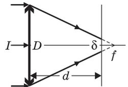
рез единичную площадку на поверхности доски,  $I_1 = I \left( \frac{D}{\delta} \right)^2 = I \left( \frac{f}{f-d} \right)^2$ .
