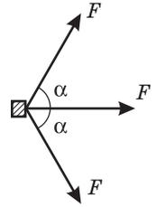
Решение. Обозначим через  $\tau$  время действия силы  $F$ . По закону изменения импульса имеем  $F\tau = mv_0$ , где  $m$  — масса бруска,  $v_0$  — скорость, которую он приобретает в результате действия силы  $F$  (импульсом силы трения за время  $\tau$  по условию можно пренебречь). По закону изменения механической
