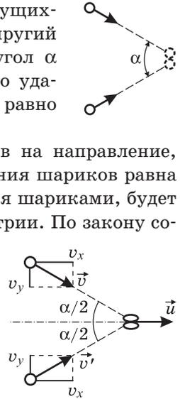
Решение. Из условия задачи ясно, что шарики испытывают нецентрально соударение (см. рисунок). Введем координатную систему, ось  $Ox$  которой направим вдоль линии первоначального движения шариков, а ось  $Oy$  — перпендикулярно этой линии, и запишем закон сохранения импульса в проекции на эти оси:  $mv_1 - mv_2 = mu_{2x}$ ,  $mu_1 - mu_{2y} = 0$ . Выражая
