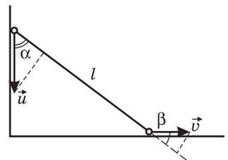
**Решение.** Поскольку длина стержня постоянна, проекции скоростей шариков на направление стержня в каждый момент времени совпадают. Обозначив через  $\vec{u}$  скорость верхнего шарика, имеем (см. рисунок):  $u \cos \alpha = v \cos \beta = v \sin \alpha$ , откуда  $u = v \operatorname{tg} \alpha$ , где  $\operatorname{tg} \alpha = \frac{\sqrt{l^2 - h^2}}{h}$ . Из закона сохранения механической энергии шариков следует
