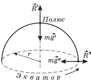
и, по второму закону Ньютона,  $m\omega^2 r = mg - R''$ , где  $\omega$  — угловая скорость вращения планеты. Поэтому вес тела на экваторе по величине равен  $P'' = R'' = mg - m\omega^2 r = \frac{\eta}{100\%} mg$ , откуда  $\omega^2 = \frac{g}{r} \left(1 - \frac{\eta}{100\%}\right)$ . В то же время,  $g = \frac{GM}{r^2}$ , где  $M = \frac{4}{3}\pi r^3$  — масса планеты.
