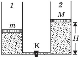
**Решение.** При закрытом кране внутренние энергии газов в сосудах 1 и 2 равны, соответственно:  $U_1 = \frac{3}{2}\nu RT = \frac{3}{2}pV = \frac{3}{2} \cdot \frac{mg}{S}hS = \frac{3}{2}mgh$ ,  $U_2 = \frac{3}{2}MgH$ ,
