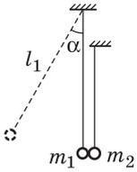
**Решение.** Пусть  $v_0$  — модуль скорости первого шарика непосредственно перед соударением со вторым шариком,  $v_1$  и  $v_2$  — горизонтальные проекции скоростей шариков сразу после соударения. Из законов сохранения энергии и импульса вытекают равенства:  $\frac{m_1 v_0^2}{2} = m_1 g l_1 (1 - \cos \alpha)$ ,
