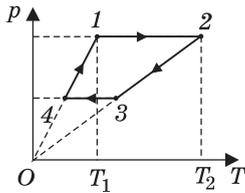
кую работу  $A$  совершает такой двигатель за один цикл, если  $T_1 = 300$  К,  $T_2 = 1000$  К, а при нагревании на участке  $4-1$  давление газа увеличивается в 2 раза? Универсальная газовая постоянная  $R = 8,3$  Дж/(моль · К).
