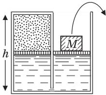
Р е ш е н и е. В исходном состоянии системы (с грузом на поршне) давление газа  $p = p_0 + \frac{2Mg}{h^2}$ , его объем  $V = \frac{h^3}{4}$ . Уравнение состояния газа имеет
