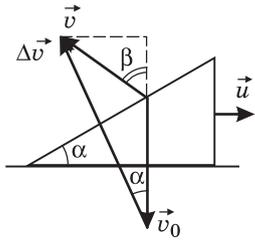
Решение. Поскольку смещения шарика и клина за время соударения пренебрежимо малы и трение отсутствует, силы взаимодействия шарика и клина направлены по нормали к наклонной плоскости. Следовательно, изменение импульса шарика  $\Delta\vec{p} = m\Delta\vec{v}$  при ударе также будет направлено по нормали к наклонной плоскости клина (см. рисунок, где  $\vec{v}_0$  и  $\vec{v}$  — скорости шарика до и после удара соответственно;  $\vec{u}$  — скорость клина после удара). Из рисунка видно, что
