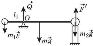
$m_1gl_1 + F'(l - l_1) = m_2g(l - l_1) + mg\left(\frac{l}{2} - l_1\right)$ . По третьему закону Ньютона, модуль искомой силы равен модулю силы  $\vec{F}'$ .
