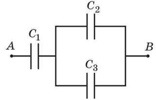
**Решение.** Поскольку все конденсаторы были первоначально незаряжены, после подключения цепи к источнику заряд на конденсаторе  $C_1$  будет равен суммарному заряду на конденсаторах  $C_2$  и  $C_3$ , т. е.  $q_1 = q_2 + q_3$ . Учитывая, что конденсаторы  $C_2$  и  $C_3$  соединены параллельно, можно записать равенство  $q_1 = (C_2 + C_3)U_2$ .
