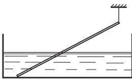
Решение. Силы, действующие на спицу, изображены на рисунке, где  $m\vec{g}$  — сила тяжести,  $\vec{T}$  — сила натяжения нити,  $\vec{F}_A$  — архимедова сила,
