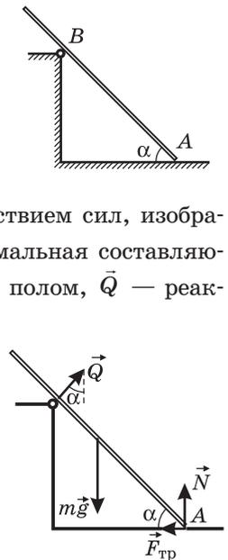
**1.4.11.** Деревянная линейка выдвинута за край стола на  $\alpha = 1/4$  часть своей длины. При этом она не опрокидывается, если на ее свешивающийся конец положить груз массой не более  $m_1 = 250$  г. На какую часть длины  $\beta$  можно выдвинуть за край стола эту линейку, если на ее свешивающийся конец положен груз массой  $m_2 = 125$  г?
