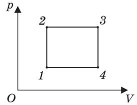
Решение. Работа газа в циклическом процессе численно равна площади, ограниченной графиком процесса на  $pV$ -диаграмме. Вводя для давлений и объемов газа в характерных точках цикла обозначения, приведенные на рисунке, имеем  $A = (p'' - p') \cdot (V'' - V')$ .
