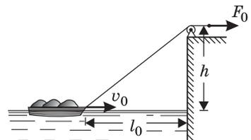
Решение. Лодка движется равномерно под действием двух сил: горизонтальной составляющей силы натяжения веревки и силы сопротивления воды. Модули этих сил на рисунке обозначены через  $F_x$  и  $\beta v_0$ , где  $\beta$  — коэффициент сопротивления воды. По второму закону Ньютона, имеем:  $F_x = \beta v_0$ . Из рисунка видно, что  $F_x = F \cos \vartheta$ , где  $\vartheta$  — угол, который веревка образует с горизонта-
