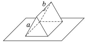
**Решение.** Выделим тонкий слой воды толщиной  $\Delta y$ , находящийся на глубине  $y$ . Площадь боковой стенки, соответствующая толщине этого слоя,  $\Delta S = \frac{b\Delta y}{\sin 60^\circ} = \frac{2b\Delta y}{\sqrt{3}}$ . Гидростатическое давление воды на глубине  $y$  равно  $p(y) = \rho gy$ . Поэтому модуль силы давления воды, действующей со стороны выделенного слоя на каждую из боковых стенок,
