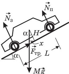
сунке, где  $M\vec{g}$  — сила тяжести,  $\vec{F}_{\text{тр}}$  — сила трения покоя, действующая со стороны дороги на ведущие (задние) колеса,  $\vec{N}_{\text{п}}$  и  $\vec{N}_{\text{з}}$  — нормальные составляющие сил реакции дороги, действующие, соответственно, на передние и задние колеса. Записывая уравнение моментов относительно оси, проходящей через точки соприкосновения
