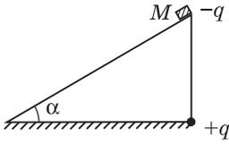
**Решение.** Выберем в качестве нулевого уровня потенциальной энергии тела в поле тяготения Земли основание наклонной плоскости, а качестве точки с нулевой потенциальной энергией притяжения зарядов — бесконечно удаленную точку. По закону сохранения механической энергии, имеем равенство  $Mgh - \frac{q^2}{4\pi\epsilon_0 h} = -\frac{q^2}{4\pi\epsilon_0 h} \operatorname{tg}\alpha + \frac{Mv^2}{2}$ .
