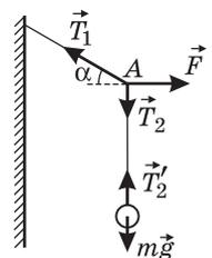
$T_1 \sin \alpha = T_2$ . Из последнего соотношения, с учетом того, что по условию  $T_1 = 2T_2$ , находим:  $\sin \alpha = \frac{1}{2}$ , т. е.  $\alpha = 30^\circ$ . Следовательно,  $F = 2mg \cos 30^\circ$ .
