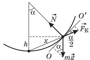
удобно записать в проекции на касательную к сфере, проведенную в плоскости рисунка (линию  $OO'$ ). С учетом известной из геометрии теоремы об угле, образованном касательной и хордой, имеем:  $mg \sin \alpha = F_K \cos \frac{\alpha}{2}$ , или
