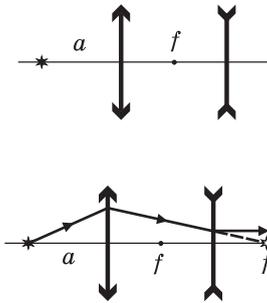
Решение. Пучок света после рассеивающей линзы будет параллельным, если продолжения падающих на нее лучей пересекаются в ее заднем фокусе (см. рисунок). Для этого изображение источника, даваемое собирающей линзой, должно располагаться на расстоянии  $f$  позади рассеивающей линзы или на расстоянии  $3f$  от собирающей линзы. Расстояние  $a$ , на котором надо поместить источник света перед собирающей линзой, можно найти по формуле
