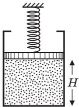
**Решение.** При нагревании газ будет расширяться, совершая работу по подъему поршня и сжатию пружины:
