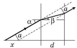
Применяя формулу тонкой линзы  $\frac{1}{2F - x} + \frac{1}{2F + b} = \frac{1}{F}$ , после несложных преобразований получаем:  $b = \frac{Fd(n-1)}{nF - d(n-1)} \approx 0,34$  см.
