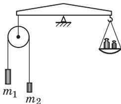
**Решение.** Когда блок заторможен, сила натяжения верхней нити, удерживающей его в равновесии, равна суммарной силе тяжести, действующей на грузы:  $T' = (m_1 + m_2)g$ . При освобождении блока грузы придут в движение, и сила натяжения верхней нити станет равной  $T'' = 2T$ , где  $T$  — модуль силы натяжения нижней нити, связывающей грузы (см. рисунок). Чтобы найти  $T$ , воспользуемся уравнениями движения грузов:
