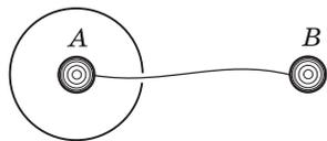
Решение. Рассмотрим вначале случай, когда шарики не соединены. При этом потенциал шарика  $B$  равен нулю:  $\varphi_B = 0$ , а потенциал шарика  $A$  равен потенциалу поверхности заряженной сферы:
