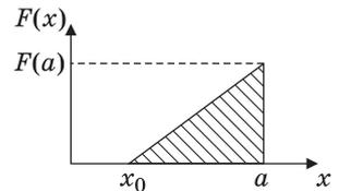
погружающей куб в воду, от  $x$  имеет вид:  $F(x) = \rho_{\text{в}}ga^2(x - x_0)$ . Работа этой силы на перемещении  $(a - x_0)$  может быть вычислена графическим способом как площадь заштрихованного треугольника (см. рисунок):  $A = \frac{1}{2}F(a)(a - x_0)$ .
