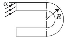
**Решение.** Ход луча, падающего на искривленную поверхность пластинки под наименьшим углом  $\delta$ , изображен на рисунке.
