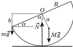
Решение. Под действием веса мухи сфера займет наклонное положение, изображенное на рисунке, где через  $\vec{N}$  обозначена сила реакции стола. Уравнение
