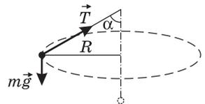
ная энергия шарика относительно положения, занимаемого им в неподвижном состоянии,  $E_{\text{п}} = mgl \cos \alpha$ . По закону изменения механической энергии, искомая работа  $A = E_{\text{к}} + E_{\text{п}} = mgl \cos \alpha \left( \frac{1}{2} \operatorname{tg}^2 \alpha + 1 \right)$ . Поскольку
