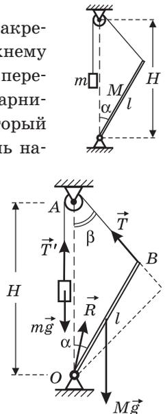
$mgH \sin \beta = Mg \frac{l}{2} \sin \alpha$ . Отсюда  $m = M \frac{l}{2H} \cdot \frac{\sin \alpha}{\sin \beta}$ . Из теоремы синусов, записанной для  $\triangle AOB$ , следует равенство  $\frac{|AB|}{\sin \alpha} = \frac{l}{\sin \beta}$ . По теореме косинусов, для того же треугольника  $|AB| = \sqrt{l^2 + H^2 - 2lH \cos \alpha}$ . Объединяя записанные выражения, получаем:  $m = \frac{M}{2} \sqrt{1 + \left(\frac{l}{H}\right)^2 - 2\frac{l}{H} \cos \alpha} \approx 7$  кг.
