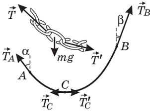
В нижней части рисунка изображены силы натяжения, действующие на отрезки цепочки  $AC$  и  $CB$ . Из соображений симметрии ясно, что силы, возникающие в точке  $C$ , а именно  $\vec{T}_C$  и  $\vec{T}'_C$ , направлены горизонтально. При этом  $T'_C = T_C$ . Условия равновесия цепочки имеют вид:  $T_A \sin \alpha = T_C$ ,  $T_B \sin \beta = T_C$ ,  $T_A \cos \alpha + T_B \cos \beta = mg$ . Исключая из этих равенств углы  $\alpha$  и  $\beta$ ,
