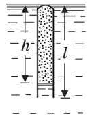
**Решение.** До погружения в воду в пробирке находилась смесь сухого воздуха и водяного пара, причем давление этой смеси  $p_0 = p_{\text{в}} + p_{\text{н}}$ , где  $p_{\text{в}}$  — парциальное давление воздуха,  $p_{\text{н}} = f p_{\text{н}}$  — парциальное давление пара. Отсюда  $p_{\text{в}} = p_0 - f p_{\text{н}}$ . После погружения пробирки в воду
