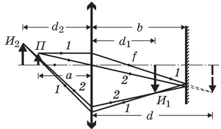
изображение, даваемое линзой, оказывается позади зеркала. Отраженные от зеркала лучи (например, лучи 1 и 2) образуют действительное изображение  $I_1$ ,
