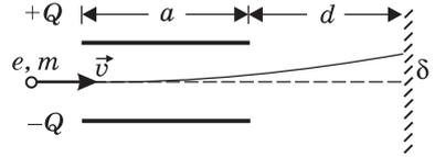
**Решение.** Поскольку в задаче требуется найти смещение электронов, вызванное действием конденсатора, электрическим взаимодействием между электронами можно пренебречь и считать, что на каждый электрон, находящийся внутри конденсатора, действует сила  $F = eE$ , направленная вертикально вверх (здесь  $e$  — модуль заряда электрона,
