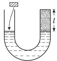
Р е ш е н и е. Брусок массой  $m$ , плавающий в жидкости плотностью  $\rho$ , вытесняет объем  $V = m / \rho$ . В результате уровни жидкости в трубке повышаются:
