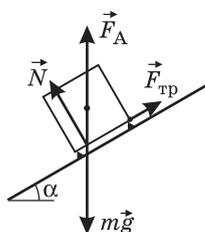
**Решение.** Кубик находится в равновесии под действием трех сил: силы тяжести  $m\vec{g}$ , архимедовой силы  $\vec{F}_A$  и силы реакции со стороны подставок, которую удобно разложить на две составляющие: нормальную к наклонному дну составляющую  $\vec{N}$  и силу трения  $\vec{F}_{\text{тр}}$  (см. рисунок).
