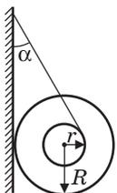
**Решение.** Силы, действующие на катушку, изображены на рисунке, где  $m\vec{g}$  — сила тяжести,  $\vec{T}$  — сила натяжения нити,  $\vec{F}_{\text{тр}}$  — сила трения,  $\vec{N}$  — нормальная составляющая силы реакции стены. Запишем условия равновесия катушки в виде: для горизонтальных проекций сил:  $T \sin \alpha = N$ , для моментов
