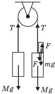
Решение. Тела движутся под действием сил, изображенных на рисунке, где  $Mg$  и  $mg$  — силы тяжести,  $T$  — сила натяжения нити,  $F$  — сила взаимодействия груза с перегрузком. Уравнения движения тел имеют вид:  $Ma = T - Mg$  (для левого груза),  $Ma = Mg + F - T$  (для правого груза),  $ma = mg - F$  (для перегрузка). Из этой системы находим:  $F = \frac{2Mm}{2M + m}g = 0,95 \text{ Н}$ .
