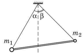
Решение. Шарика находятся в равновесии под действием сил, изображенных на рисунке, где  $m_1\vec{g}$  и  $m_2\vec{g}$  — силы тяжести,  $\vec{T}_1$  и  $\vec{T}_2$  — силы натяжения нитей,  $\vec{F}$  и  $\vec{F}'$  — силы реакции стержня. Поскольку стержень невесом и находится в покое,  $F' = F$ .
