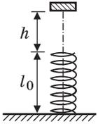
**Решение.** Условие равновесия бруска, неподвижно лежащего на пружине, имеет вид:  $mg = k(l_0 - l_1)$ , где  $m$  — масса
