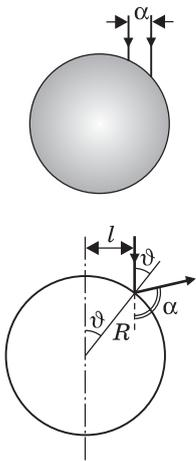
**Р е ш е н и е.** Ход луча, падающего на шар на некотором расстоянии  $l$  от оси, параллельной лучу и проходящей через центр шара, изображен на рисунке, где  $\vartheta$  — угол падения,  $\alpha$  — угол отклонения луча от первоначального направления. Видно, что  $\alpha + 2\vartheta = \pi$ ,  $l = R \sin \vartheta$ . Отсюда получаем формулу, связывающую расстояние  $l$  от луча до оси и угол  $\alpha$  отклонения луча:  $l = R \sin \frac{\pi - \alpha}{2} = R \cos \frac{\alpha}{2}$ .
