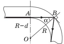
санные соотношения, получаем:  $R_{\min} = \frac{nd}{n-1} = 3$  мм.
