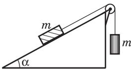
Решение. Сила  $\vec{F}$ , с которой нить действует на блок, равна векторной сумме сил натяжения  $\vec{T}'$  и  $\vec{T}''$ , приложенных в точках схода нити с блока (см. рисунок). Поскольку нить и блок невесо-
