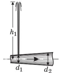
**Решение.** Уравнение Бернулли для воды, текущей по трубе, имеет вид:  $p_1 + \frac{1}{2}\rho v_1^2 = p_2 + \frac{1}{2}\rho v_2^2$ , где  $p_1$ ,  $v_1$  и  $p_2$ ,  $v_2$  — давления и скорости воды в сечениях диаметрами  $d_1$  и  $d_2$ , соответственно,  $\rho$  — плотность воды. Из уравнения неразрывности течения следует, что  $v = \frac{1}{4}\pi d_1^2 v_1 = \frac{1}{4}\pi d_2^2 v_2$ . Отсюда
