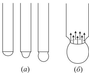
ется шейка, диаметр которой, вообще говоря, несколько меньше внутреннего диаметра трубки. Сила поверхностного натяжения воды, действующая перпендикулярно окружности этой шейки (рисунок (б)), удерживает каплю от падения. Отрыв капли происходит при выполнении условия  $\pi d_{\text{ш}} \sigma = mg$ , где  $d_{\text{ш}}$  — диаметр шейки. Полагая приближенно, что диаметр шейки равен внутреннему диаметру трубки, получаем:  $m = \frac{\pi d \sigma}{g} = 0,023 \text{ г}$ .
