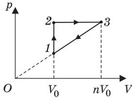
Решение. Работа газа в циклическом процессе равна  $A = \frac{1}{2}(p_2 - p_1)(nV_0 - V_0) = \frac{1}{2}(n - 1)^2 p_1 V_0$ . Газ получает теплоту на участках  $1-2$  и  $2-3$ , поэтому полное количество теплоты, полученное газом
