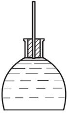
эффицент объемного расширения спирта  $\alpha = 1,1 \cdot 10^{-3} \text{ К}^{-1}$ , его плотность при начальной температуре  $\rho_0 = 0,8 \cdot 10^3 \text{ кг/м}^3$ . Тепловым расширением колбы и трубки пренебречь. Ускорение свободного падения принять  $g = 10 \text{ м/с}^2$ .
