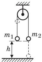
Решение. Пусть  $v$  — модуль скорости грузов в момент, когда один из них (например  $m_2$ ) коснется подставки. По закону сохранения механической энергии имеем:
