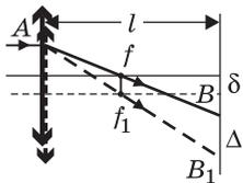
$$\text{Аналогично рассматривается случай, когда } l < f. \text{ Наконец, если перемещение линзы выходит из плоскости рисунка, то лучи, преломленные линзой в исходном и смещенном ее положениях, по-прежнему будут лежать в одной плоскости, в которой можно рассмотреть такие же подобные треугольники. Следовательно, связь между смещениями линзы и светового пятна на экране во всех случаях имеет один и тот же вид.}$$
