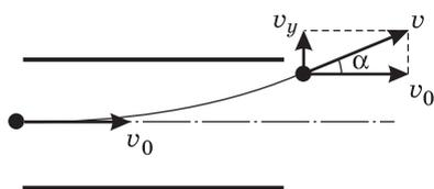
$= F_1 \Delta t$ , где  $F_1$  — сила, действующая на электрон со стороны поля конденсатора,  $\Delta t$  — время пролета конденсатора. Обозначив через  $l$  длину пластин конденсатора, находим,
