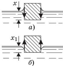
сила. Отсюда глубина погружения смачиваемого водой кубика  $x = \frac{mg + 4a\sigma}{a^2 \rho g} \approx 5,4$  мм. Когда кубик покрывают
