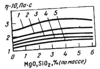
Рис. 7.7.38. Изотермы вязкости расплавов CaO-Al 2 O 3 -MgO-SiO 2 при 1773 К (1), 1823 К (2), 1873 К (3), 1923 К (4), 1973 К (5). Состав расплавов, % (по массе): 55 CaO-43 Al 2 O 3 -1 SiO 2 -1 MgO; 53 CaO-41 Al 2 O 3 -3 SiO 2 -3 MgO; 50 CaO-38 Al 2 O 3 -6 SiO 2 -6 MgO. Метод 1. Тигель и шпindel из молибдена [363]
