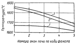
Рис. 72. Изменение температуры по длине рабочего пространства 500-т газовой печи в период доводки
