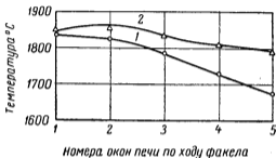
Рис. 73. Изменение температуры по длине рабочего пространства в период доводки при тепловой нагрузке 37—38 млн. ккал/час:
