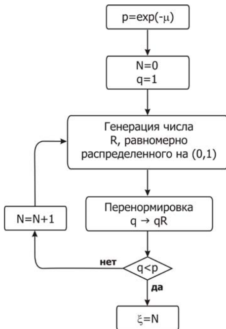
Рис. 11.4. Блок-схема алгоритма получения случайных чисел, распределенных по закону Пуассона
