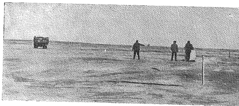
Рис. 74. Определение коэффициента трения льда в натуральных условиях.
