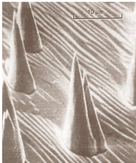
Рис. 6.6. Полученное с помощью сканирующего электронного микроскопа изображение поверхности кристаллов олова, подвергшихся бомбардировке ионами аргона с энергией 5 кэВ (Stewart and Thompson, 1969).
