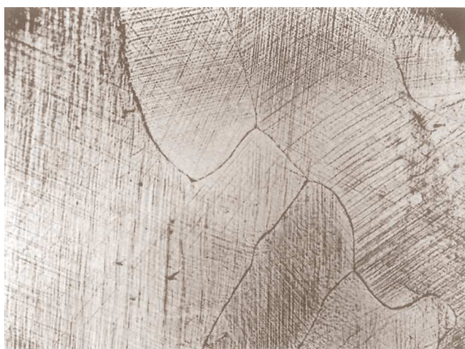
Рис. 3.10. Микроснимок, выполненный Розенхайном, изображающий линии скольжения в зернах свинца
