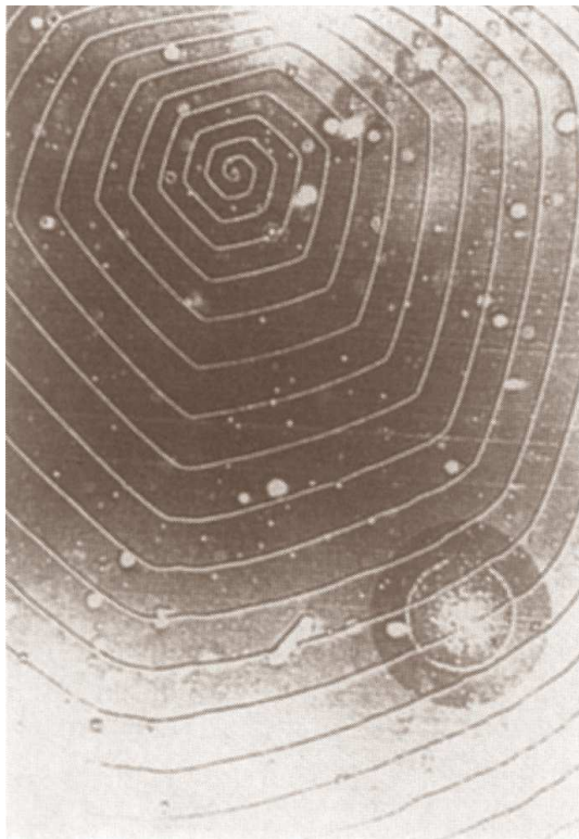
Рис. 3.23. Рост по спирали кристалла карбида кремния, начинающийся в точке возникновения винтовой дислокации (изображение предоставлено профессором С. Амелинksom)
