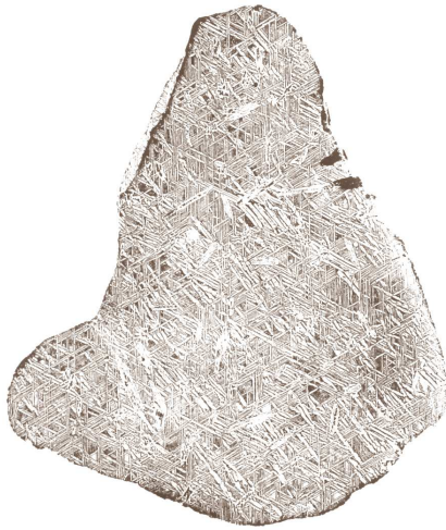
Рис. 3.4. Элбогенский железный метеорит, рассеченный, отполированный и протравленный. Рисунок выполнен с помощью пропитки протравленного сечения чернилами и использования его в качестве формы для печати. Изображение увеличено вдвое. Взято из опубликованной в 1820 году книги Карла фон Шрайберса, основанной на наблюдениях фон Видманштедта в 1808 году (по Smith, 1960, p. 151). Микроструктура такого рода сейчас известна как структура Видманштедта
