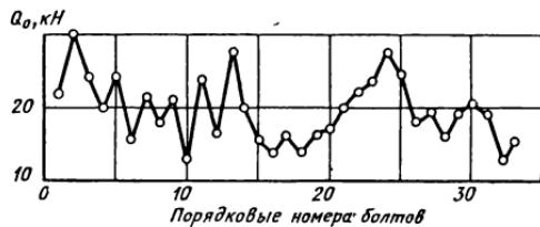
Рис. 9. Усилия затяжки в болтах 5/8" при  $M_3=8 \text{ кН} \times \text{см} = \text{const}$
