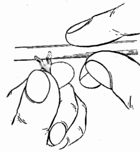
Фиг. 46. Уменьшение длины вилки путем опилования рожков.
