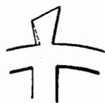
Фиг. 63. Увеличение притяжки путем срезания зуба. Пунктирная линия показывает место среза.
