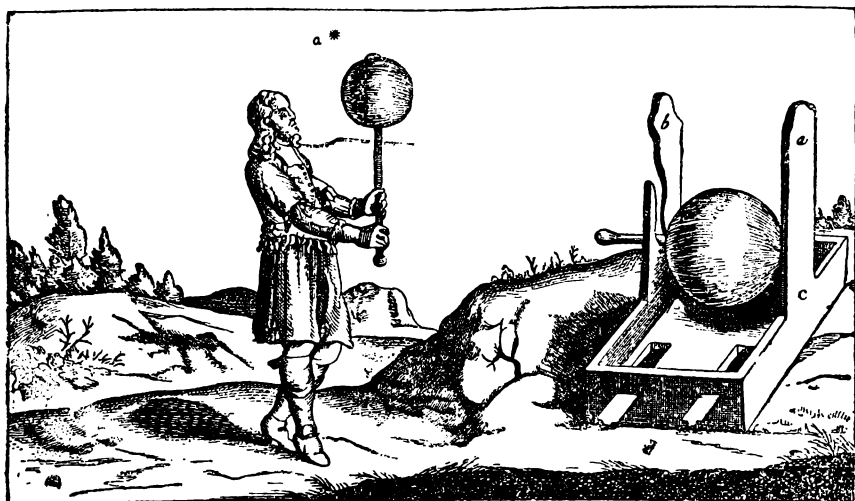
Рис. 36. Электрическая машина Герике 1 .
