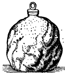
Рис. 28. Опыт академиком сжимаемости воды 2 .
