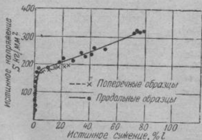
Фиг. 135. Диаграммы деформации стали хромансиль вдоль и поперек волокна (Фридман и Ратнер).
