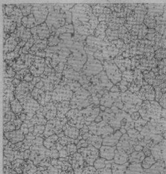
Фиг. 359. Микроструктура стали РФ1 после закалки от 1240°. \times 500 .
