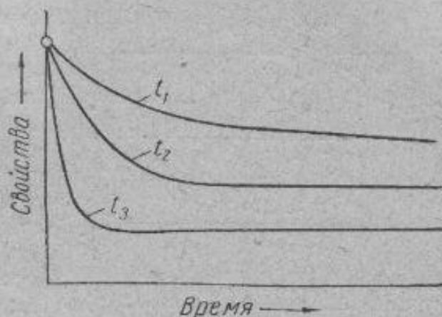
Фиг. 212. Схема, показывающая изменение свойств в зависимости от продолжительности отпуска. Температура отпуска t_1 < t_2 < t_3 .
