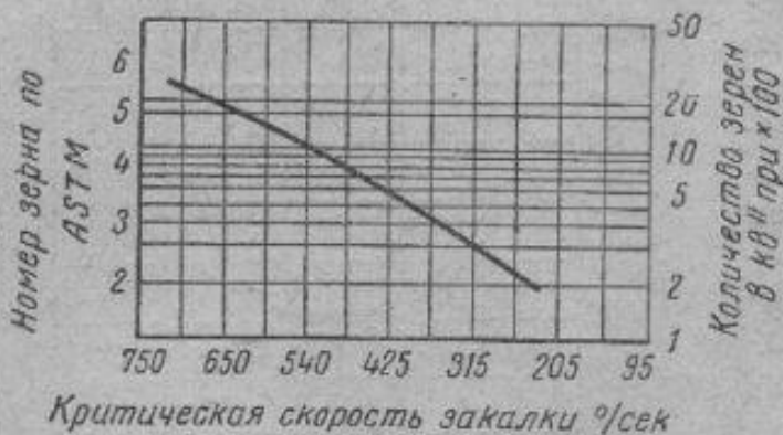
Фиг. 188. Влияние размера зерна на величину критической скорости закалки (Диггес). Сталь высокой чистоты — 0,8—0,85% С.
