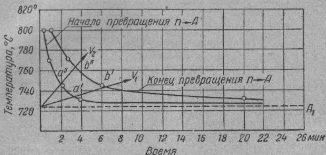
Фиг. 167. Превращение перлита в аустенит при постоянной температуре (Миркин и Блантер). Сталь 0,86% С.
