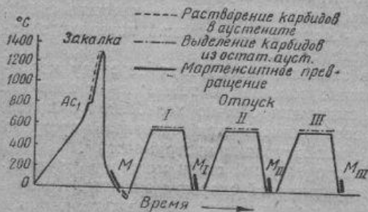
Фиг. 370. Схема закалки и многократного отпуска быстрорежущей стали марки РФ1.
