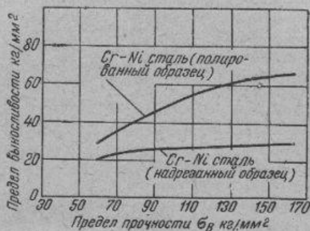
Фиг. 328. Предел выносливости полированного и надрезанного образца из хромоникелевой стали при разной прочности.
