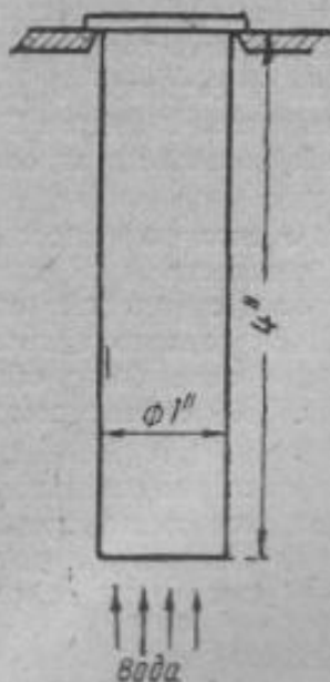
Фиг. 229. Схема закаливания образца при испытании на прокаливаемость методом торцевой закалки.
