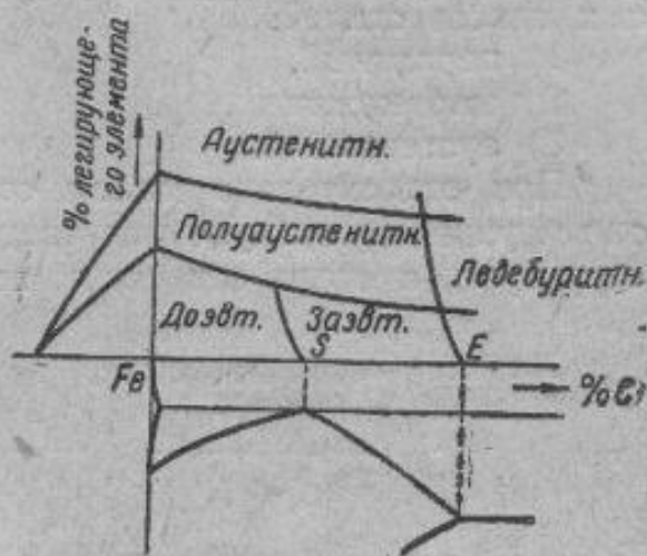
Фиг. 322. Распределение по классам сталей в тройной системе Fe—C—л. э., в которой легирующий элемент расширяет \gamma -область.
