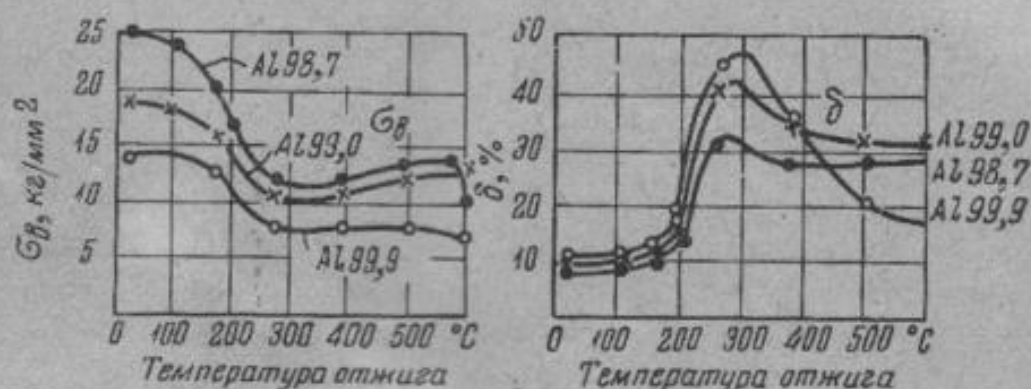
Фиг. 416. Влияние температуры отжига на свойства алюминия различной чистоты (Закс).
