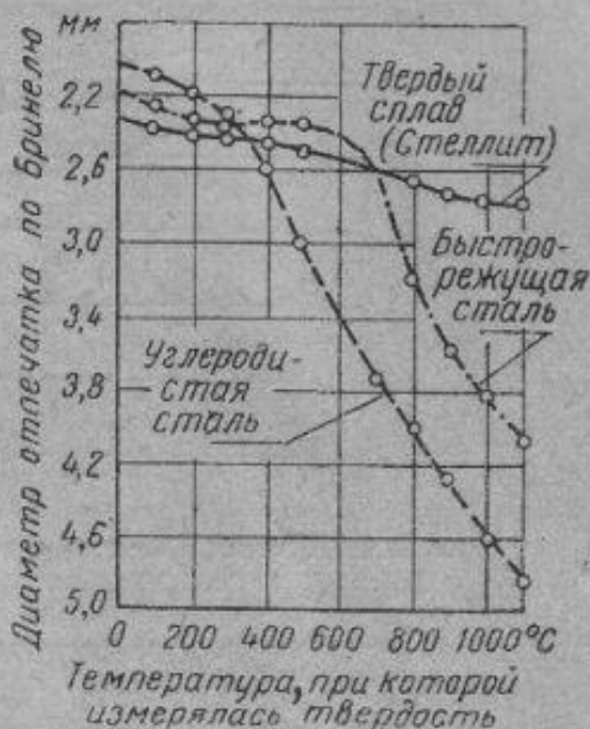
Фиг. 353. Твердость в нагретом состоянии различных инструментальных сплавов.
