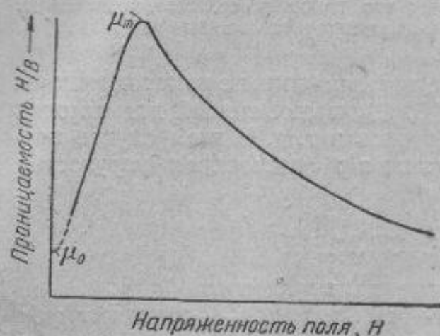
Фиг. 404. Магнитная проницаемость в зависимости от напряженности поля.
