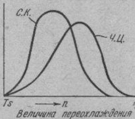
Фиг. 21. Скорость роста кристаллов и скорость зарождения центров в зависимости от степени переохлаждения (случай 1).
