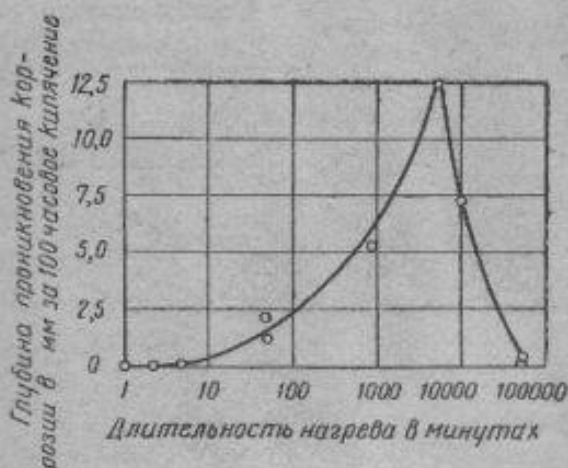
Фиг. 395. Глубина проникновения интеркристаллитной коррозии в зависимости от длительности пребывания стали в опасном районе температур (при 650^\circ ) (Бэйн, Эборн и Рутерфорд).
