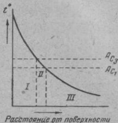
Фиг. 246. Распределение температуры от поверхности в глубину изделия при нагреве кислородно-ацетиленовым пламенем.
