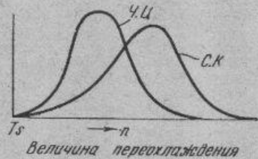
Фиг. 22. Скорость роста кристаллов и скорость зарождения центров в зависимости от степени переохлаждения (случай 2).
