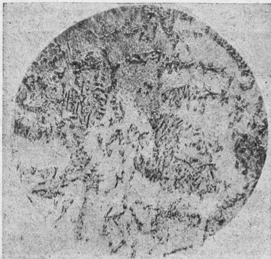
Рис. 49. Перегретая при отжиге сталь крупной поковки. Увел. в 750 раз
