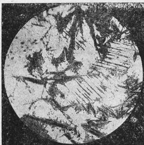
Рис. 68 Аустенит в цементационном слое сильно перецементованном и закаленной хромоникелевой стали с 1% хрома и 4% никеля. Увел. в 100 раз.
