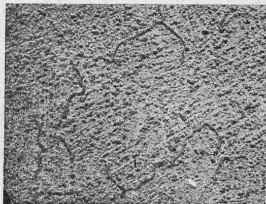
Рис. 31. Сетчатая структура литой хромоникелевой стали.
