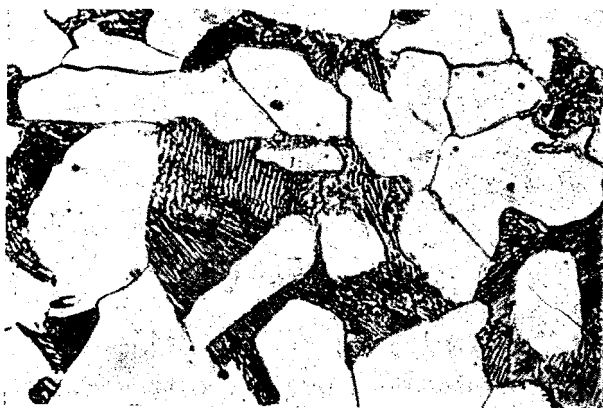
Фиг. 111. Структура стали (0,45% С). Свободный феррит и перлит при увеличении 1200.
