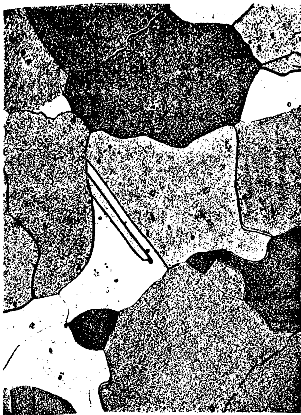
Фиг. 105. Кристаллы чистого железа, обрису кившие излучность объёмов при травлении.
