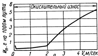
Рис. 128. График зависимости износа при трении без смазки образцов по валу (сталь У8) и удельном давлении 20 \text{ кг/см}^2 от скорости скольжения: а — образцы из сурьмы; б — из цинка.
