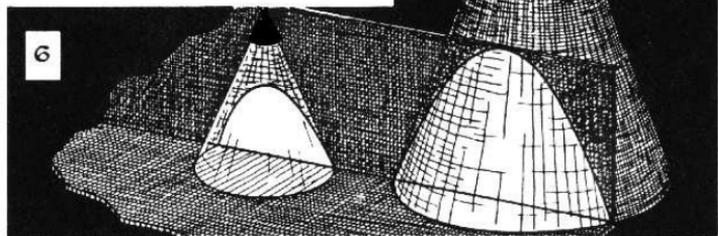
4. Если вращать гиперболу вокруг ее оси симметрии, не пересекающей ветвей, то получится поверхность, называемая *однополостным гиперboloидом*. Эта поверхность обладает удивительным свойством: она «соткана» из прямых линий. Ажурная мачта московского телецентра на Шаболовке составлена из «кусков» таких гиперboloидов, целиком сделанных из прямых стальных стержней.
