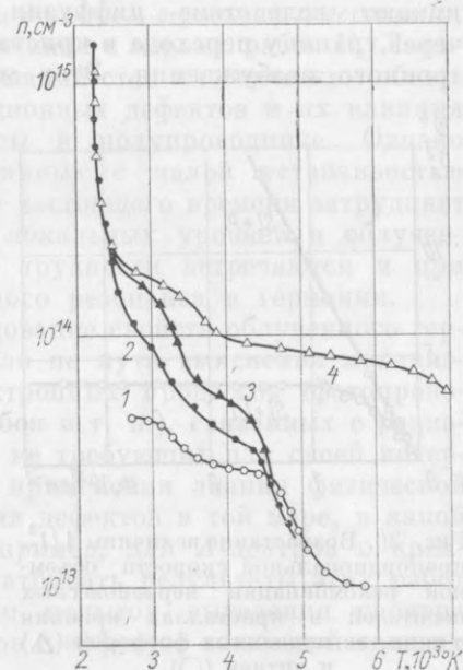
Рис. 25. Температурная зависимость концентрации дырок в образце кремния, содержащего атомы лития и остаточную концентрацию атомов бора. Проводимость после облучения стала дырочной. Отжиг в течение 1 ч при температурах: 210^\circ (1), 340^\circ (2), 390^\circ (3), 450^\circ\text{C} (4).
