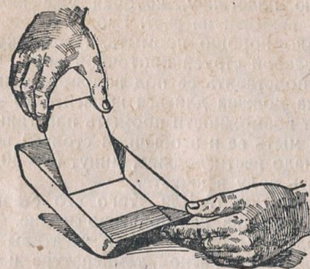
Рис. 52. Как надо погружать пластинку в проявитель.
