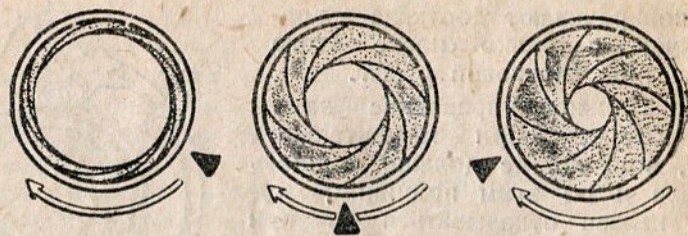
Рис. 26. Как устроена диафрагма.
