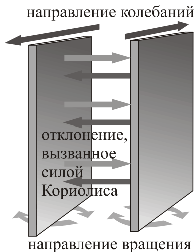
Рис. 62. Колебательный твёрдотельный гироскоп
