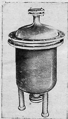
Рис. 1-5. Вакуумный химический реактор из стеклопластика, футерованный плотным полиэтиленом.
