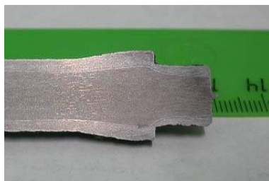
Рис. 3.27. ПКП: макроструктура биметаллического образца, сформированного из стали 45 и 20X13
