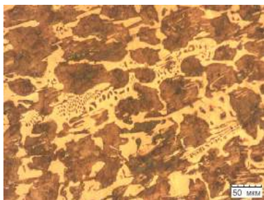
Рис. 2.3. Микроструктура доэвтектического белого чугуна
