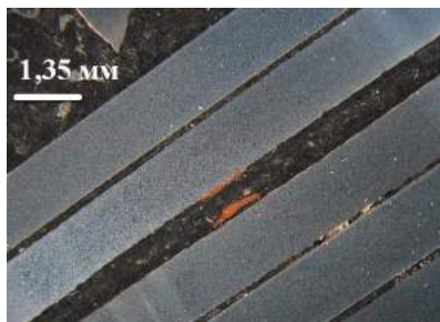
Рис. 3.12. Шлиф продольного сечения стальной проволоки диаметром 1,35 мм
