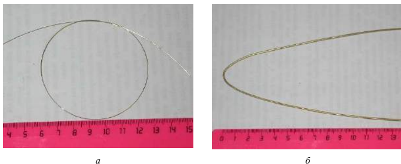
Рис. 3.11. Металлокордовая стальная проволока различных диаметров: 0,185 мм (а), 1,35 мм (б)
