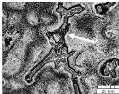
Рис. 2.35. Микроструктура БрОФ10-1: дендритная структура ( а ), эвтектоид и фосфид меди ( б )
