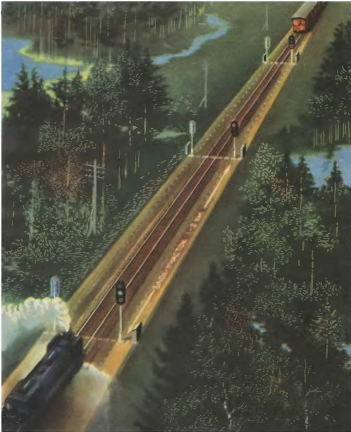
Схема однопутной автоматической блокировки. Расстояние между светофорами (блок-участок) от 1 до 3 километров.
