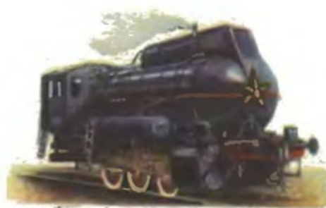
Маневровый бестопочный паровоз серии „БП“.
