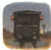
Сигналы на последнем вагоне поезда.
