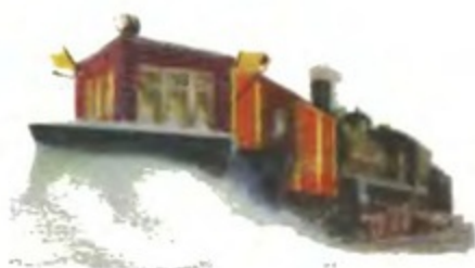
Плужовой снегоочиститель расчищает путь от снега на перегоне.
