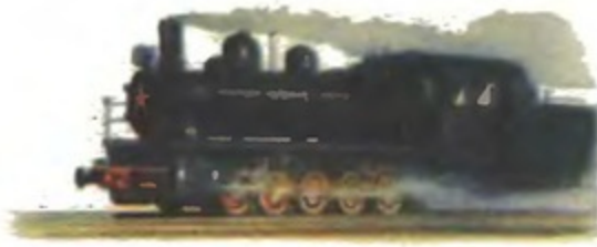
Грузовой паровоз серии „Э“.
