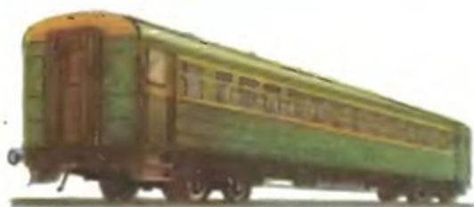
Цельнометаллический пассажирский вагон.
