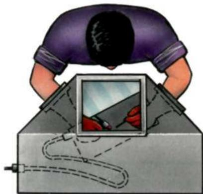
ной 40-50 мм и длиной 60-120 мм в зависимости от режима сварки. Для сварки трубчатых конструкций, кольцевых поворотных и неповоротных стыков применяют местные или малогабаритные защитные камеры.
