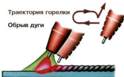
При сварке угловых и тавровых соединений сварку заканчивают перемещением горелки в обратную сторону по шву, одновременно замедляя подачу проволоки.
