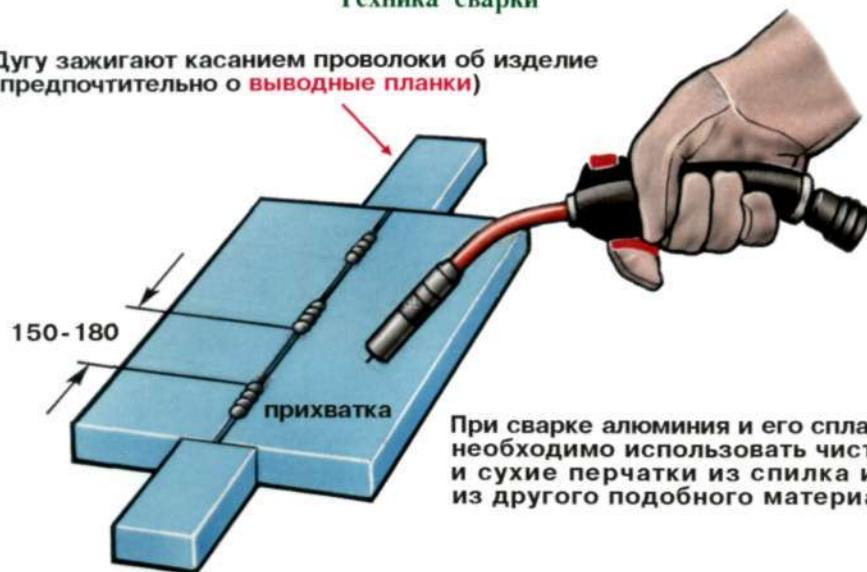
При сварке алюминия и его сплавов необходимо использовать чистые и сухие перчатки из спилка или из другого подобного материала
