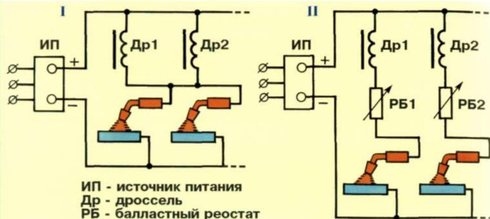
**I** - применяется при сварке на одинаковых режимах с частыми замыканиями дуги; в цепь каждого сварочного поста необходимо включать индуктивность, которая уменьшает взаимное влияние одного поста на другой.
