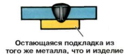
Сварку тонкого металла предпочтительно вести в вертикальном положении сверху вниз, углом назад. Металл толщиной свыше 4 мм сваривают как на весу, так и на подкладках
