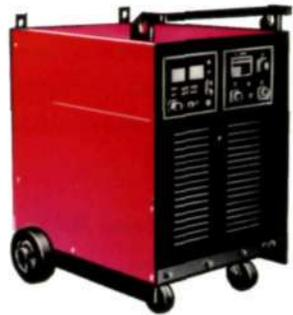
Аппараты типов ВС, ВДГ, ВСЖ имеют жесткую внешнюю статическую характеристику и предназначены для механизированной сварки. Режим регулируется изменением напряжения холостого хода за счет переключения витков первичной обмотки трансформатора, *плавно в пределах каждой ступени - дросселем насыщения.*
