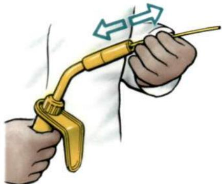
**4** До начала сварки проверить осевую «игру» (люфт) проволоки в канале горелки (ориентировочно 8-12 мм).
