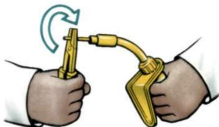
**6** В процессе сварки следить за надежной затяжкой токоподводящего наконечника.
