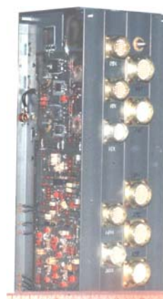
Блок автоматики и стабилизации 14М101 СЭП малых КА серии «Гонец» (1999 г.)
