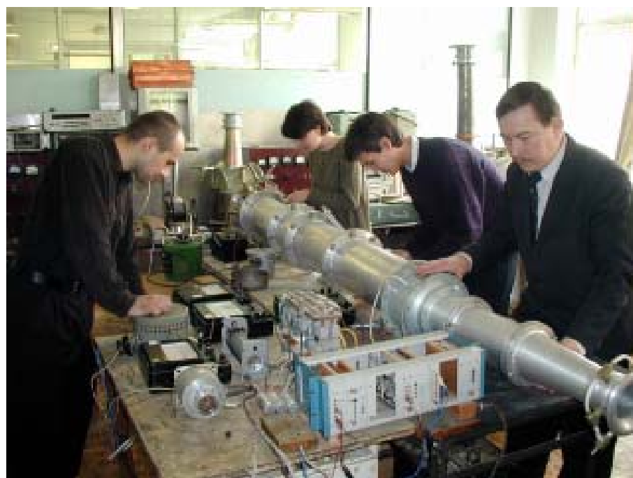
Аэродинамические испытания электровентилятора скоростного электропоезда «Сокол». А.И. Лоскутников с сотрудниками лаборатории
