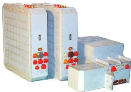
Комплекс автоматики и стабилизации КАС-М СЭП КА «Марс-96» (1992 г.)
