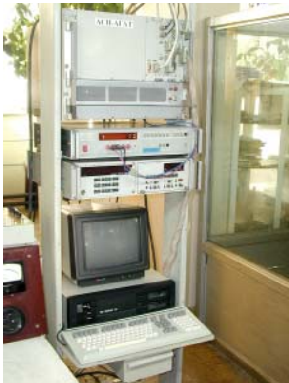
АСИ-2Д — автоматизированная система испытаний для проверки датчиков. Эксплуатируется с 1984 г.
