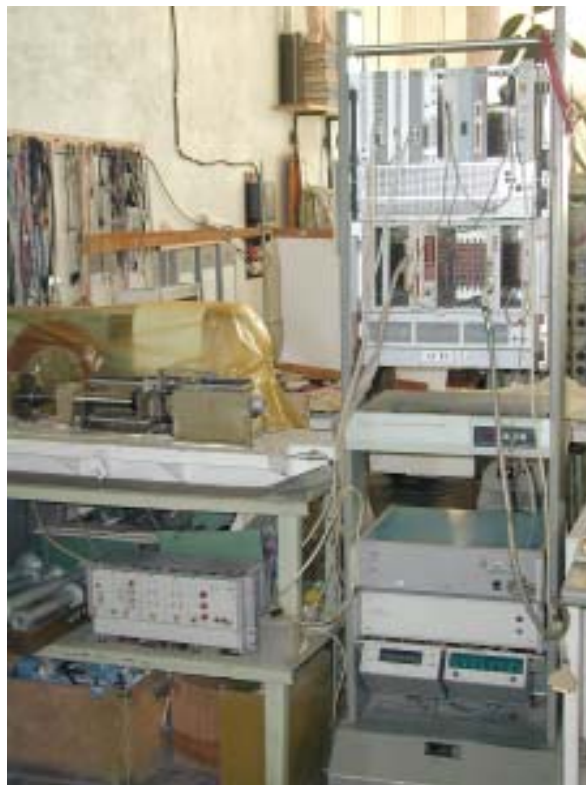
АСИ «Агат» — автоматизированная система испытаний для проверки приборов типа «Агат». Эксплуатируется с 1989–1990 гг.
