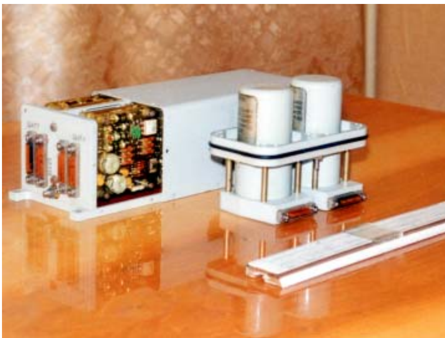
Измеритель угловых скоростей КА (БИС-5)
